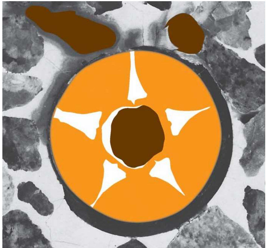
Koekappaleen poikkileikkausvalokuvassa näkyy injektointiletkun toiminta. Vaaleanharmaa massa on ensi-injektoinnin mikrosementtiä, ruskea massa jälki-injektoinnissa käytettyä epoksia.
